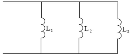
Dados:  $L_1=15\text{mH}$ ,  $L_2=30\text{mH}$  e  $L_3=10\text{mH}$ .
