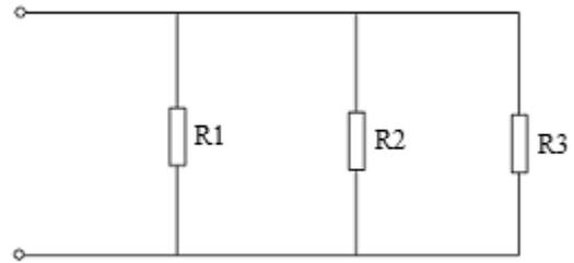
Dados  $R_1=10\Omega$ ,  $R_2=15\Omega$  e  $R_3=6\Omega$ .
